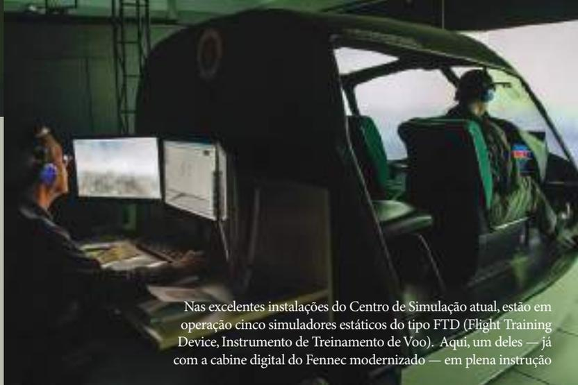
Nas excelentes instalações do Centro de Simulação atual, estão em operação cinco simuladores estáticos do tipo FTD (Flight Training Device, Instrumento de Treinamento de Voo). Aqui, um deles — já com a cabine digital do Fennec modernizado — em plena instrução
