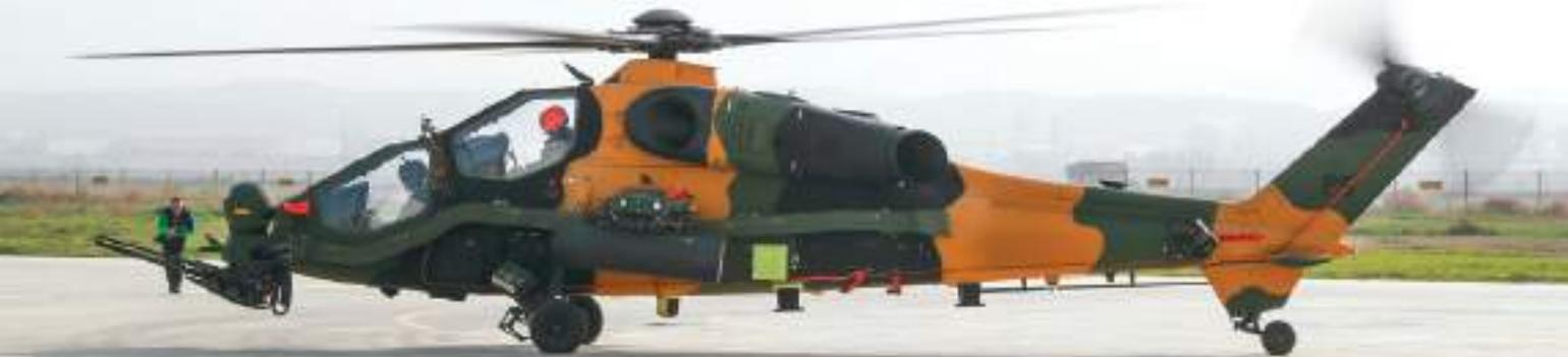
O T129 Atak tem velocidade máxima de 281 km/h; velocidade de subida de 13,26 m/s e de ascensão vertical de 7,3 m/s; com teto operacional de 4.572 m, alcance de 537 km e autonomia de voo de três horas
