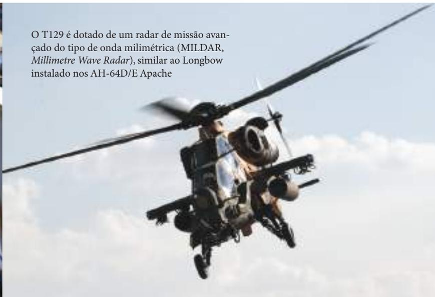
O T129 é dotado de um radar de missão avançado do tipo de onda milimétrica (MILDAR, *Millimetre Wave Radar*), similar ao Longbow instalado nos AH-64D/E Apache
