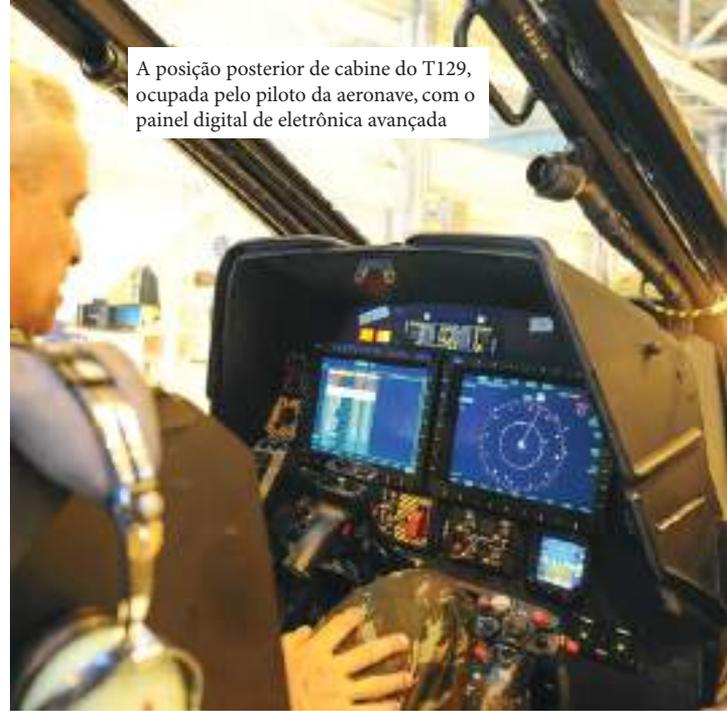
afivelados e a distância do assento ajustada, a posição de operação do comando cíclico mostrou-se confortável, permitindo ao piloto manter uma postura que não produz fadiga durante o voo.
