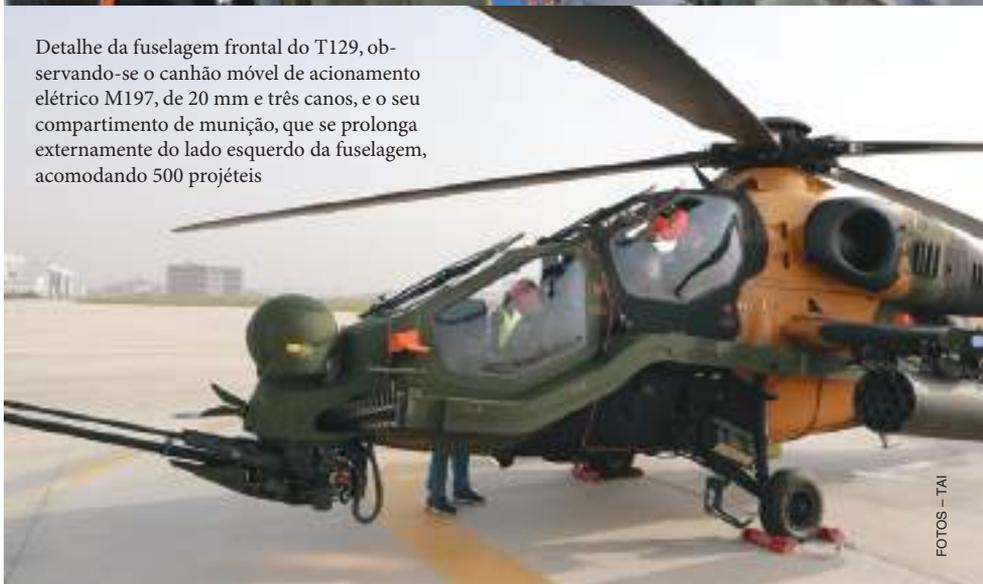
Detalhe da fuselagem frontal do T129, observando-se o canhão móvel de acionamento elétrico M197, de 20 mm e três canos, e o seu compartimento de munição, que se prolonga externamente do lado esquerdo da fuselagem, acomodando 500 projéteis
